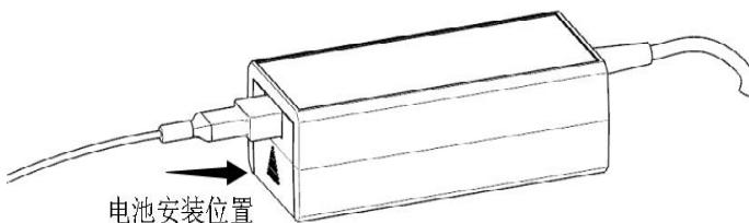
产品标配 7.4V/950mAh 两块锂电池，如上图所示：电池安装位置，本设计在插入衰减器后，衰减器起到限位作用，电池无法取出，如需取出电池充电，参考如下步骤：
